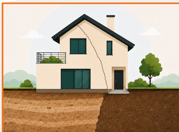
Une composition hétérogène du sol de fondation.
