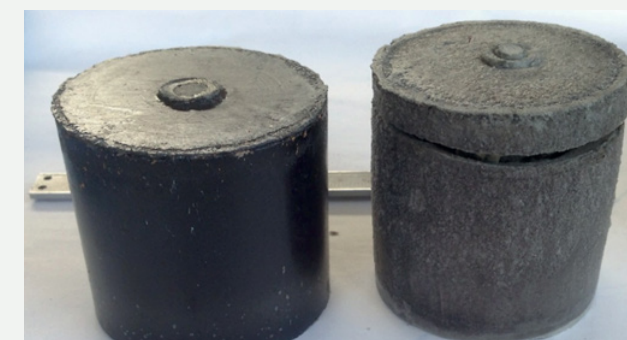
Figure 3. Exemple d'échantillon intact et fissuré pour la résine GEOPLUS 2435.
