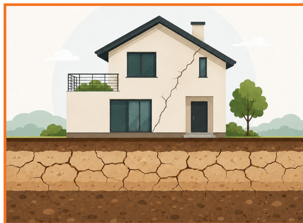
La dessiccation des couches superficielles du sol due à des périodes de sécheresse prolongées.
