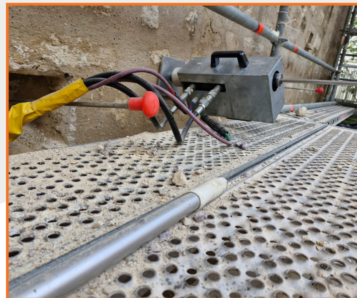
Mise en tension et réalisation d'essais à charge constante sur les micro-ancrages
