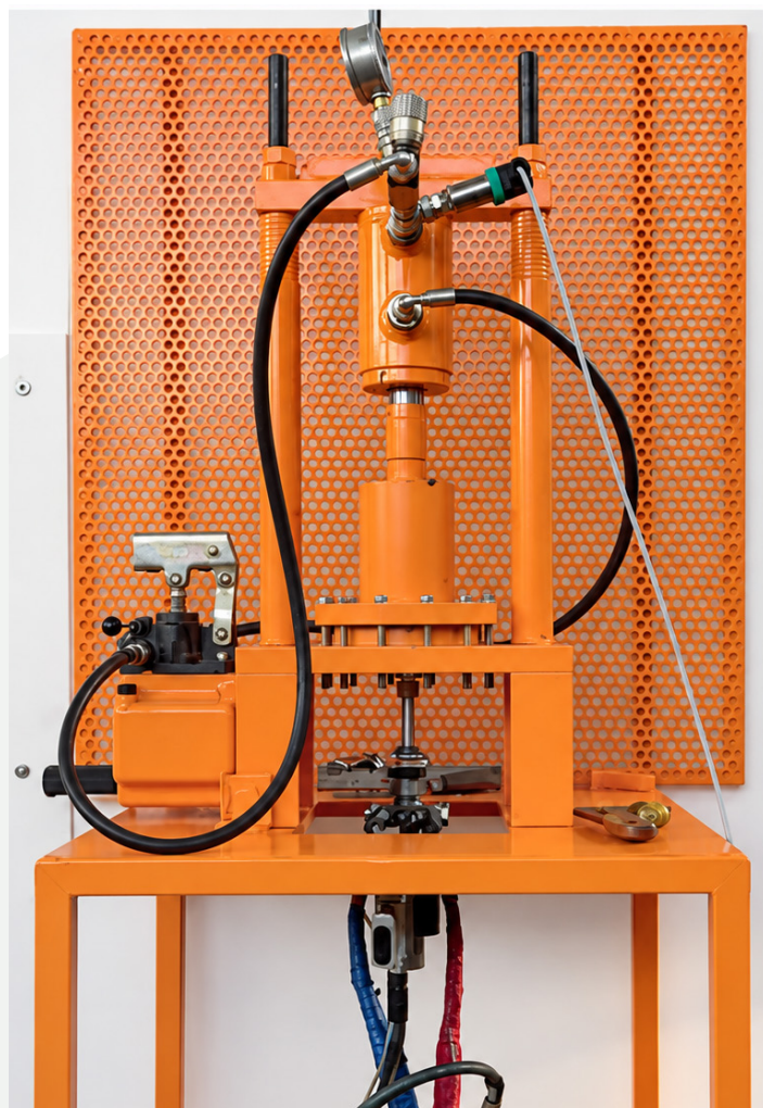
Figure 1. œdomètre à expansion contrôlée utilisé pour la réalisation des essais.
