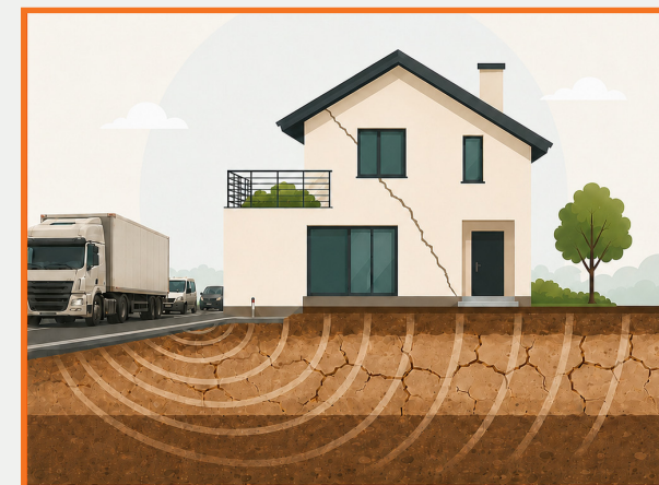
Les vibrations induites par un trafic intense à proximité du bâtiment.
