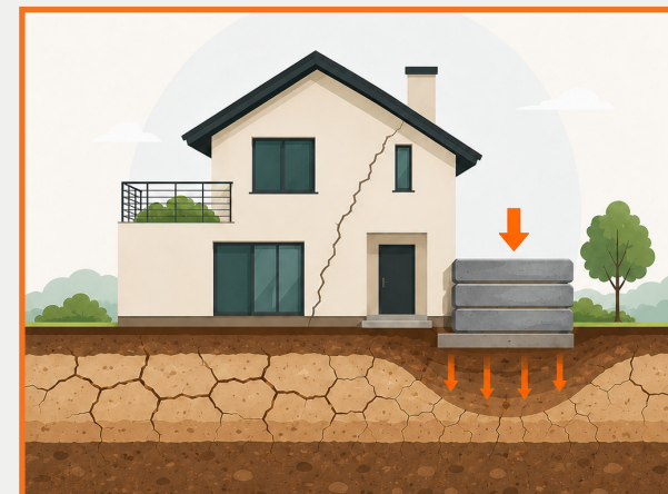
La présence de surcharges concentrées.
