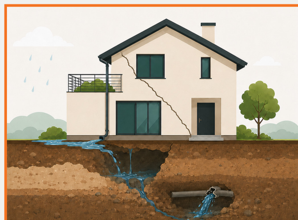
Le lessivage du sol dû à des ruptures de canalisations ou à des eaux de surface non maîtrisées.
