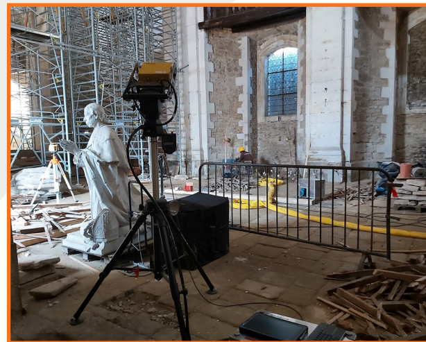
Surveillance tridimensionnelle au radar 3D avec une précision au 10 ème de mm
