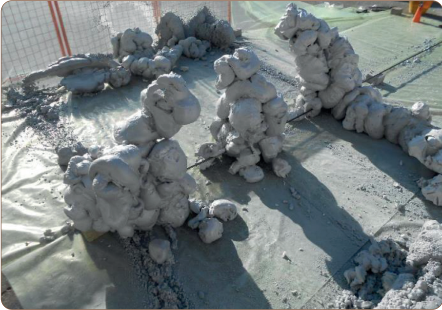
■ Figure 6.2. Essai d'injection à l'air libre dans un tube Multipoint avec schéma de percement D.
