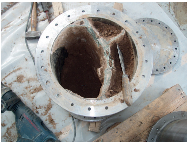
■ Figure 4.2. Résine solidifiée à l'intérieur des fractures qui se sont propagées dans le sol argileux ; vue depuis le fond du moule.
