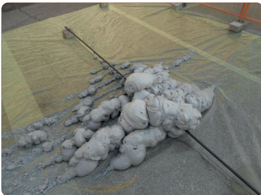
■ Figure 6.1. Essai d'injection à l'air libre dans un tube Multipoint avec schéma de percement A.
