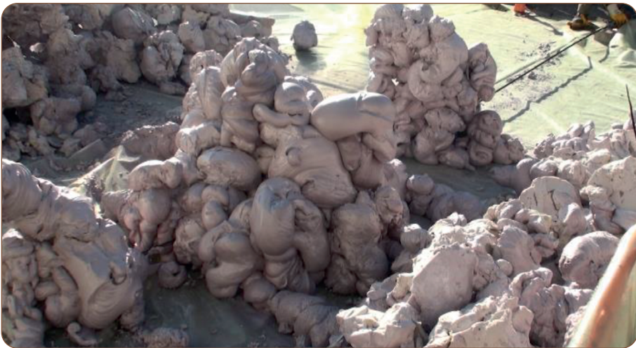
■ Figure 6.3. Essai d'injection à l'air libre dans un tube Multipoint avec schéma de percement F.
