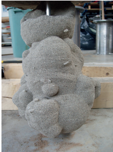
■ Figure 4.6. Agglomérat bulbiforme de résine extrait du moule.
