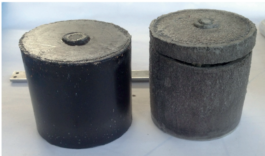
■ Figure C.4. Exemple d'échantillon intact et fissuré pour la résine GEOPLUS 2435.
