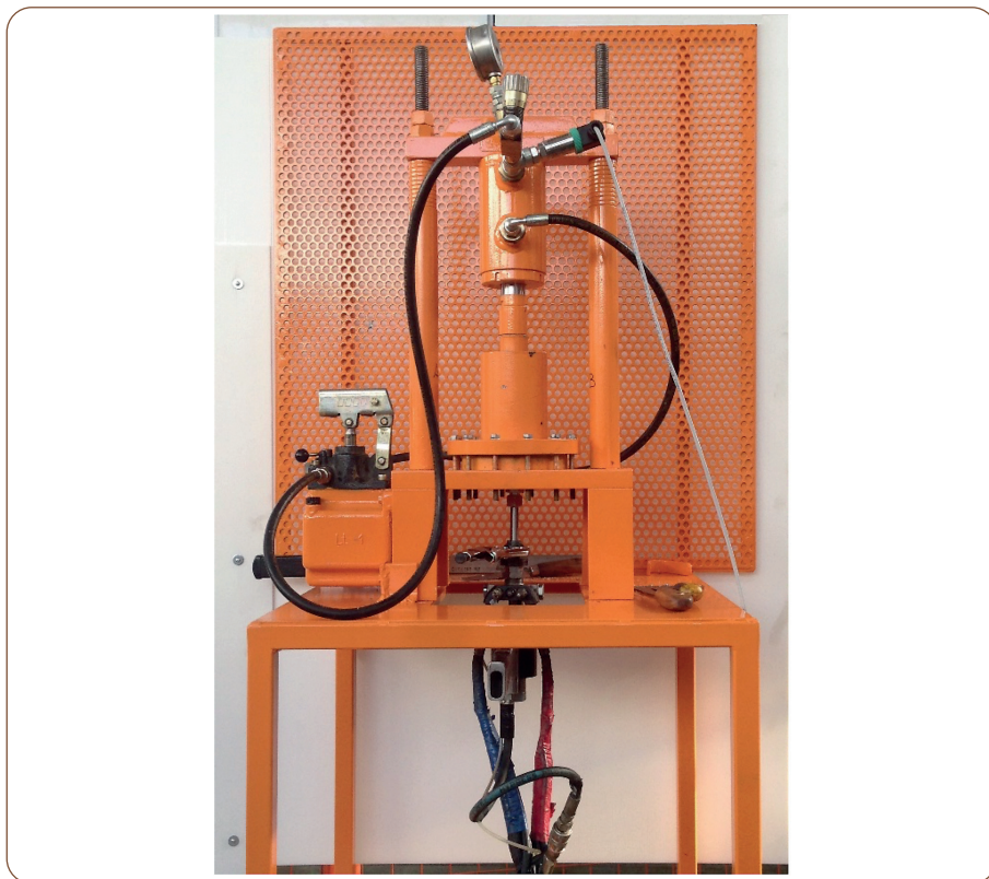
■ Figure C.2. CÉdomètre à expansion contrôlée utilisé pour la réalisation des essais.
