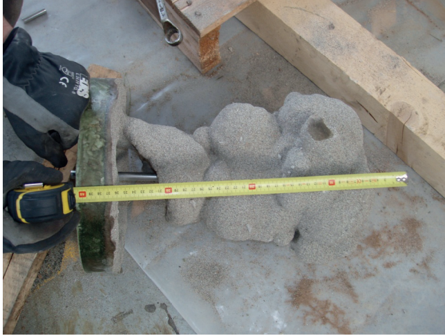
■ Figure 4.5. Taille réelle de l'agglomérat bulbiforme de résine obtenu par injection dans un échantillon de sable. Dans ce cas aussi, on a constaté la formation d'un bouchon de résine en contact avec le couvercle supérieur, où l'on avait laissé un espace vide d'environ 3 à 4 cm.
