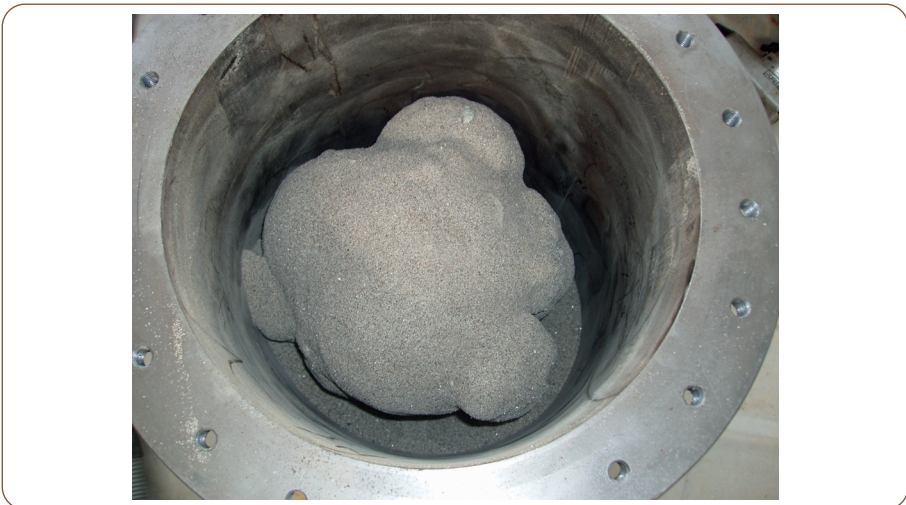
■ Figure 4.4. Agglomérat bulbiforme de résine à l'intérieur du sable ; vue depuis le fond du moule.
