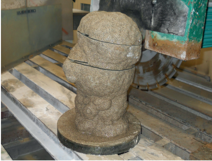
■ Figure 4.7. Photographie du bulbe reconstitué, après la réalisation de coupes transversales à l'aide d'une scie circulaire. Deux coupes ont été réalisées : une à proximité du point d'injection et l'autre plus en profondeur (on observe sur la photographie que le bulbe est présenté à l'envers, c.a.d. la tête servant de base de support).
