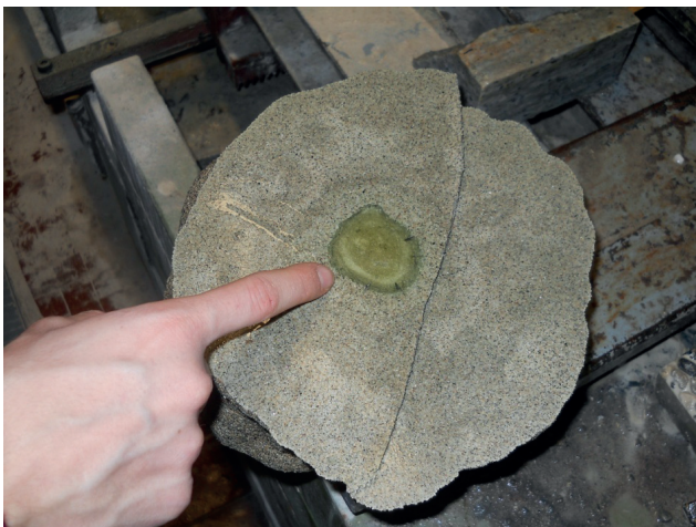
■ Figure 4.8. Coupe transversale de l'agrégat bulbiforme, réalisée à proximité du point d'injection. La résine a pénétré entre les grains de sable à partir de la zone d'injection, reconnaissable au fait qu'elle est entièrement remplie de résine pure. Autour du point d'injection, la résine a formé un agglomérat associant la résine et les grains de sable, par un processus de pénétration ou d'imprégnation.
