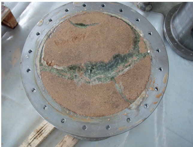
■ Figure 4.1. Ouverture du couvercle inférieur du moule contenant l'argile compactée ; on note les traces de deux fractures principales qui se sont propagées jusqu'au fond du moule.
