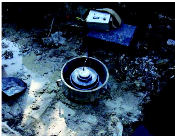
Photo 2[a]. Infiltromètre double anneau ouvert-formation n°1 (1,2 m de profondeur) Photo 2[b]. Infiltromètre simple anneau-formation n°2 (2,1 m de profondeur)
